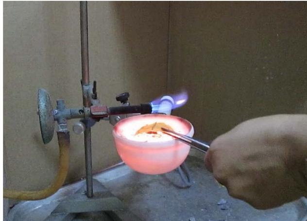
Figura 1. Montaje del ensayo de inflamabilidad
