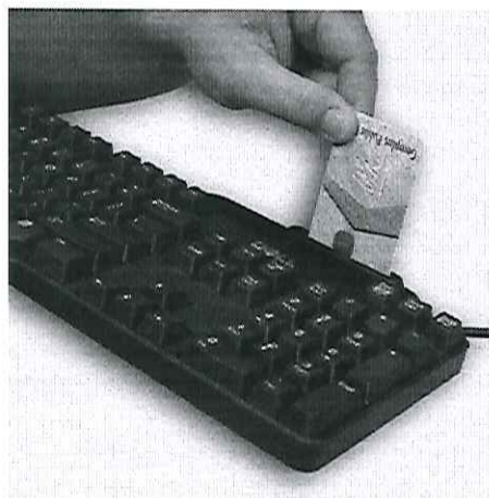
Figura 6 – Leitor Smart Card Embutido no Teclado.
