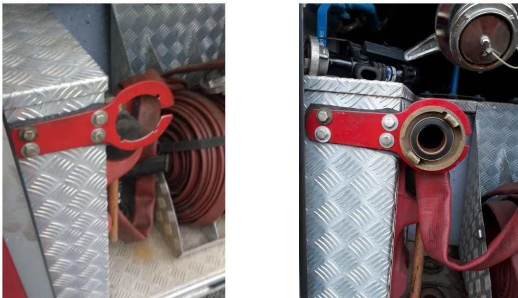
Figura 3. Instalação da chave fixa Rengaf no ABTR
