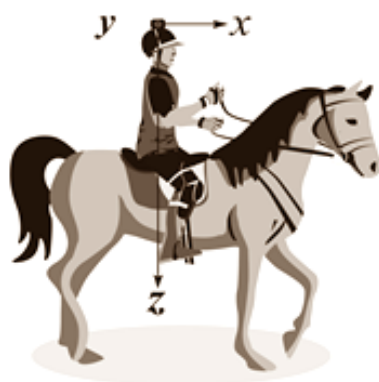
Figura 1 - Posicionamento do actímetro em cima da cabeça do voluntário. Acelerômetro e deslocamento do eixo do giroscópio: x - longitudinal, y - transversal, z - normal
